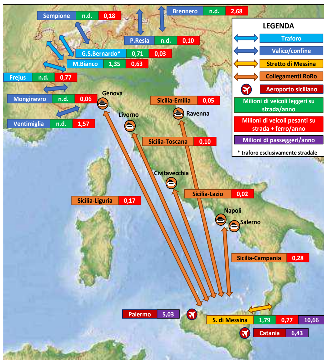
Figura 48: Traffico annuale passeggeri, veicoli leggeri e pesanti (2019), confronto tra lo Stretto di Messina ed i principali trafori/valichi/confini alpini stradali e ferroviari** e tra lo Stretto di Messina ed i principali aeroporti siciliani
